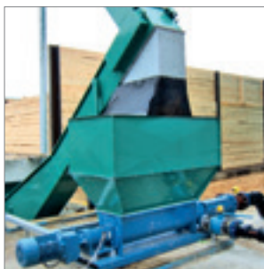
Alimentation de la pompe via une trémie de versement
