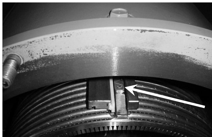
Fig.13-12 Position de montage du tamis, triangle gravé vers le haut et vers l'avant en direction du séparateur
