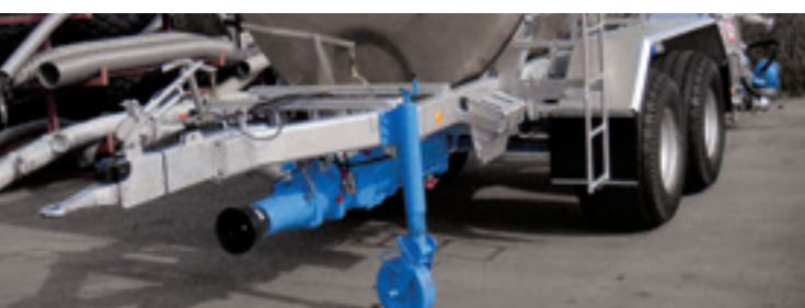
Bomba de toma de fuerza en un tanque para estiércol / camión cisterna con bomba
