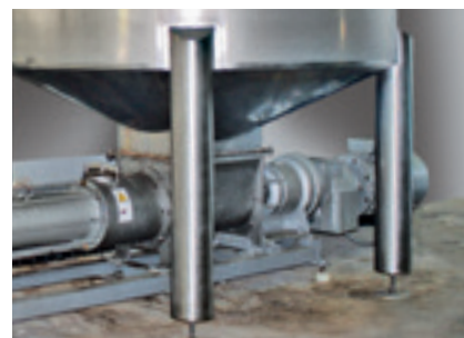
Alimentation dans une pompe à vis excentrique KL100RL120-8 V4A
